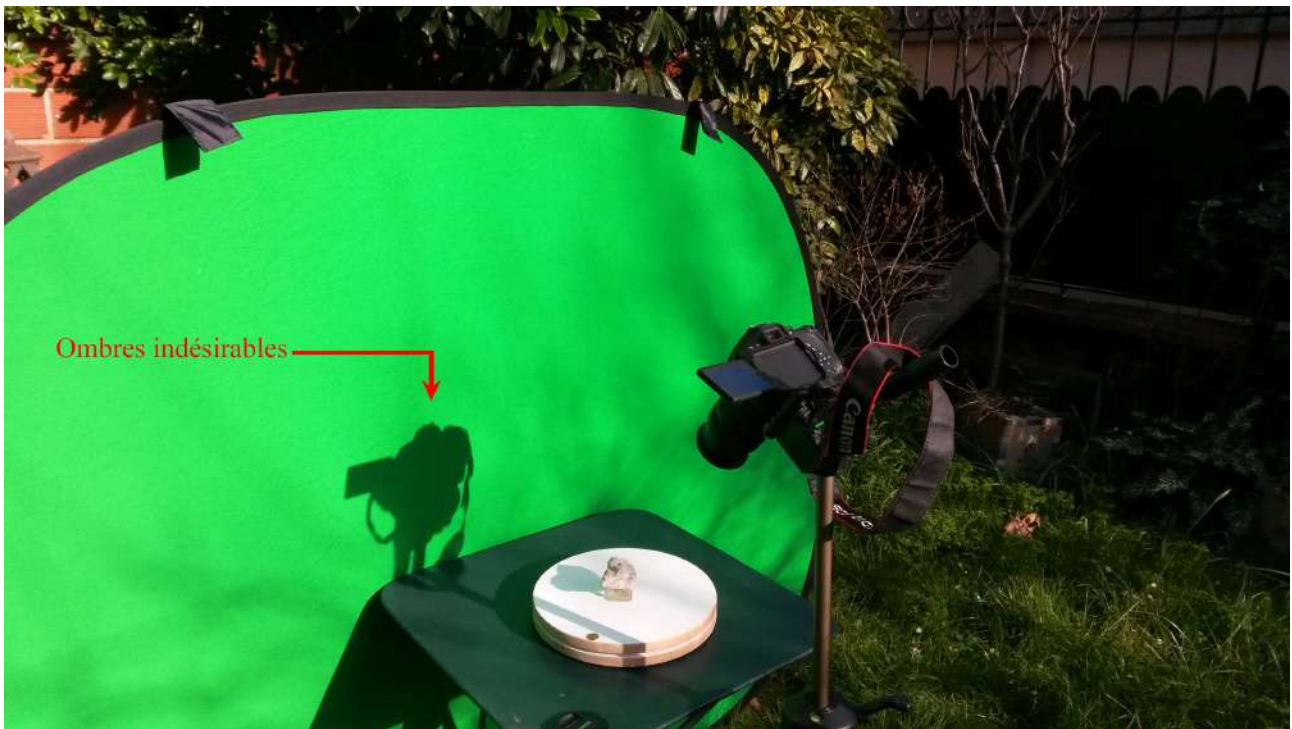
Fig 32. Installation de prise de vue pour photogrammétrie.
